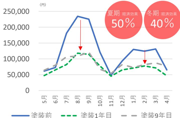
屋根塗装により、夏期は冷房効率、冬期は暖房効率を上昇し、年間を通して経済性を実現。セラミックの力で効果を長期的に持続します。
